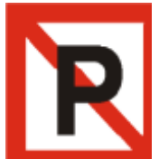
Panneau A5 Ancre ou amarrage à la rive interdit.
